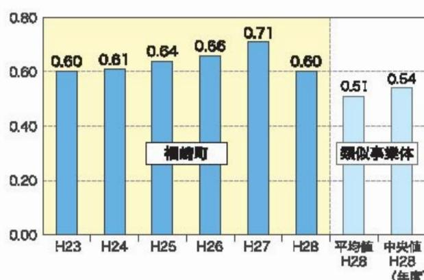
図3.4-6 配水量1m<sup>3</sup>当たり電力消費量(kWh/m<sup>3</sup>)
