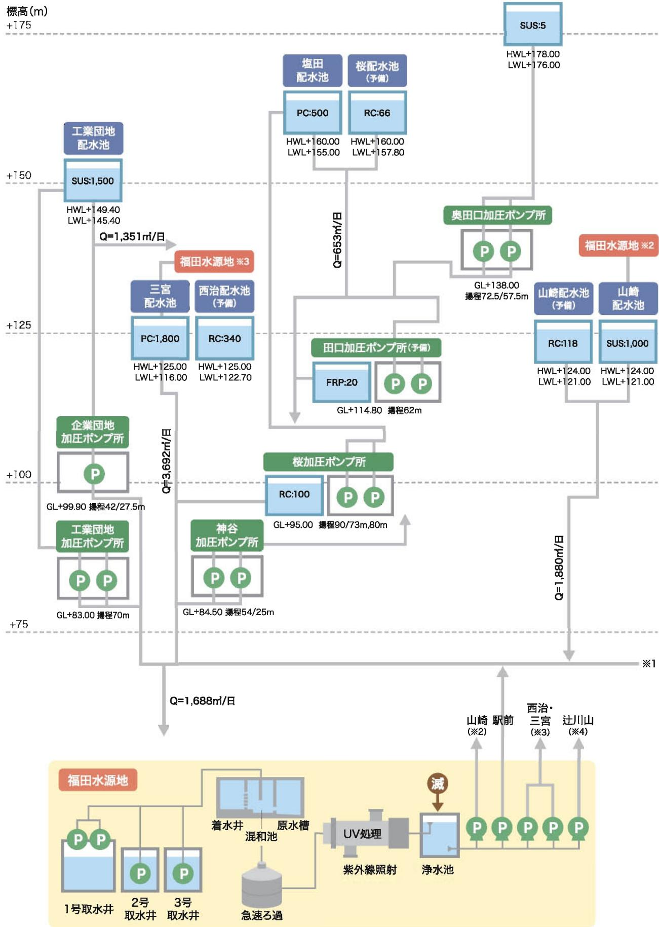
図2.3-2 水道施設フロー図
