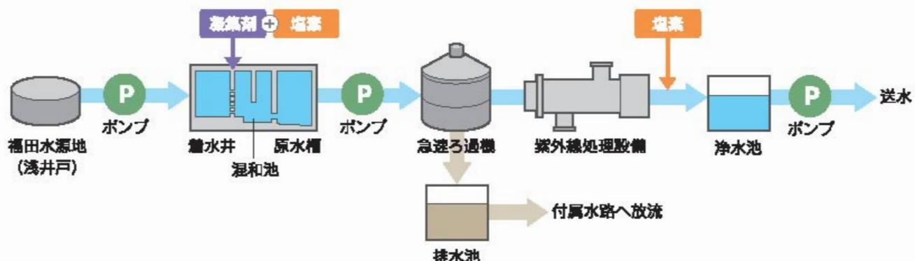
図2.3-4 福田水源地の浄水処理方法
