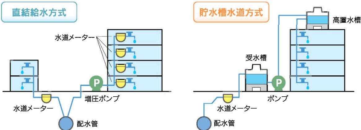
図6.1-1 直結給水方式と貯水槽水道方式
