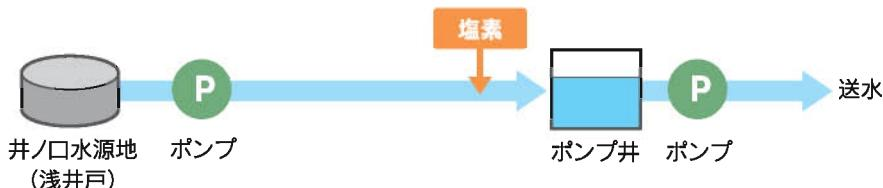
図2.3-6 井ノ口水源地の浄水処理方法
