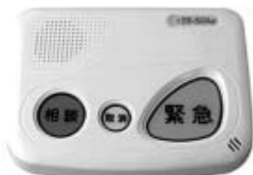
緊急通報装置
