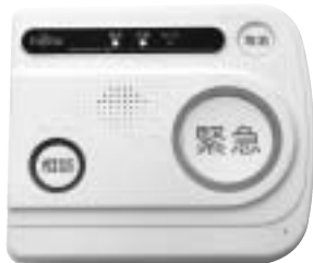
緊急通報装置
