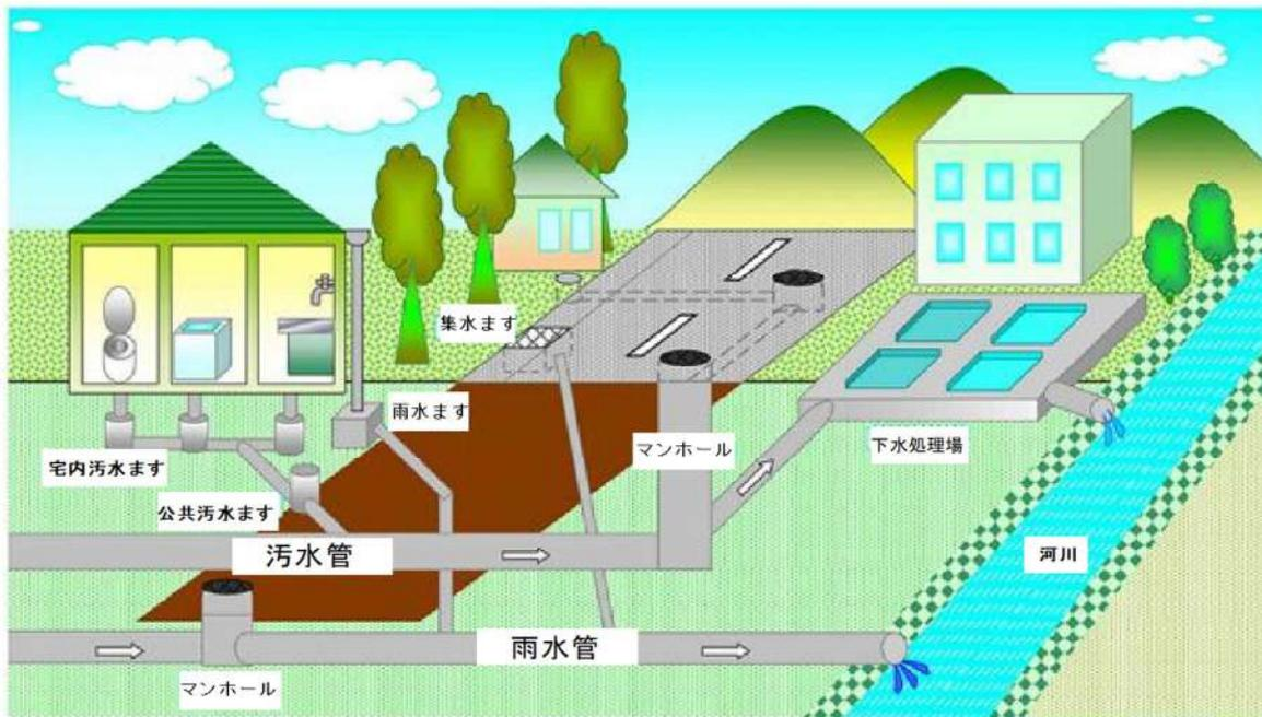
下水道の排除方法には、「分流式」と「合流式」があり、本町では分流式を採用しています。分流式とは、汚水と雨水を別々の管に集め、汚水は処理場へ、雨水は川へ流す方式です。各家庭で使った汚水は、宅地内にある排水管から公共マスを通して汚水管に流れ込みます。汚水管で集められた汚水は、下水処理場に運ばれた後、きれいに処理されて川に放流しています。雨水は、道路上にある集水ますや雨水ますに流れ込み、雨水管（雨水幹線）に集められ、川へ放流されます。
